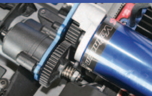
Nach der Entfernung der Getriebeabdeckung offenbart sich die integrierte Rutschkupplung
