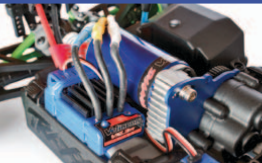
Entfalten wahnwitzige Kräfte für ein Modell in diesem Maßstab: 380er Velineon Brushless-Motor mit 4.000 kV und Velineon-Regler
