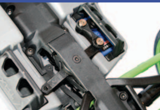
Für mehr Leistung am Lenkgestänge kann ein zusätzliches Lenkservo parallel verbaut werden
