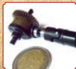
Eines der wenigen Metall-Teile am E-Revo: das Diff. Der Vergleich zum 2-Euro-Stück zeigt, wie klein es ist
