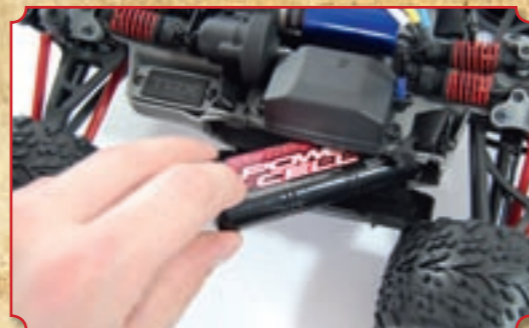
Auf jeder Chassis-Seite ist Platz für je einen Akku. Dem Set liegt zwar nur ein Sechszeller bei, für den Anfang ist das jedoch auch völlig ausreichend
