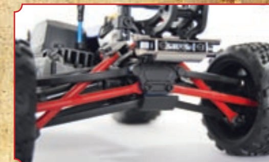
Keine Dämpfer an den Achsen – das wirkt filigran, ist es aber nicht
