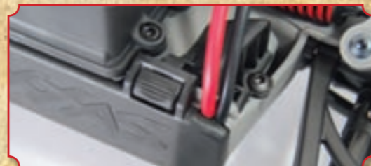
Damit die Kabel nicht abgequetscht werden, ist werkseitig eine kleine Aussparung in der Akku-Box eingearbeitet
