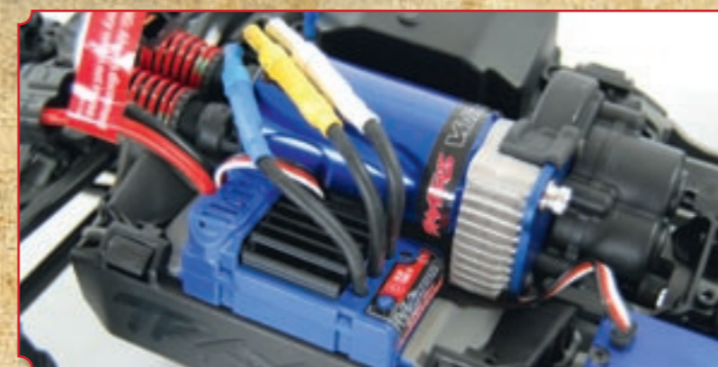
Der Regler verfügt über einen Ein-aus-Schalter, durch den die gesamte Bordelektronik gekappt wird
