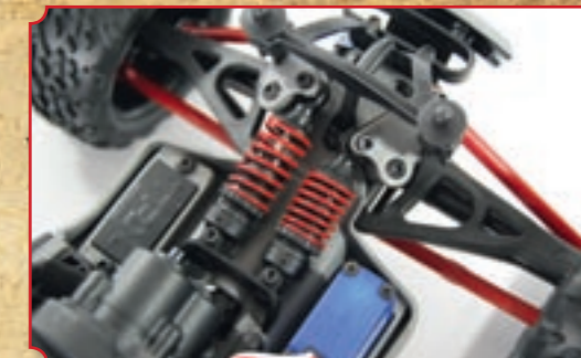
Die Absorption von Bodenunebenheiten in die Stoßdämpfer erfolgt über Umlenk-Mechaniken. Die Stoßdämpfer sind über Rändelschrauben verstellbar
