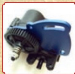
Am Aluminium-Motorträger sitzt das Hauptzahnrad mit integriertem Slipper, das die Motorkraft ans Getriebe überträgt
