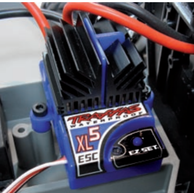
Elektronik ist normalerweise anfällig für Feuchtigkeit – der XL-5-Regler ist es nicht
