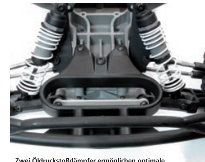
Zwei Öldruckstoßdämpfer ermöglichen optimale Anbindung der Räder an den Untergrund
