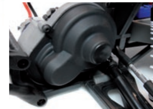
Abwehrschiacht: Eine Schutzhülle aus Kunststoff hält Schmutz und Steinchen von der Getriebeeinheit fern
