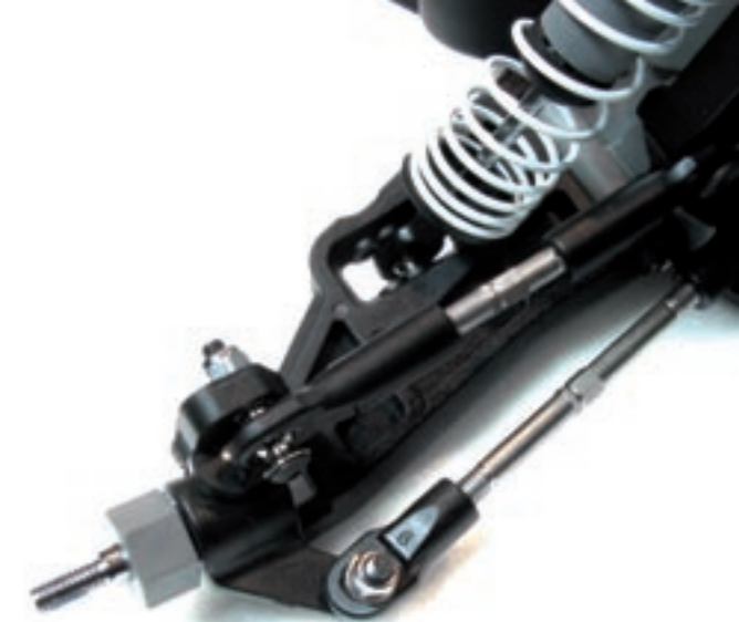
Justierung gefällig? Kein Problem, Rechts-links-Gewindestangen machen es möglich
