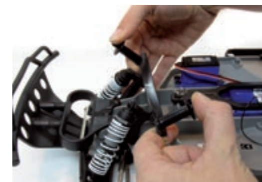
Anschmiegsam: An strategisch wichtigen Positionen wurde ein sehr flexibler Kunststoff gewählt, um Brüchen vorzubeugen
