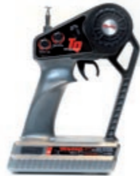
Der Sender hält alle Grundfunktionen bereit. Die Modulation in 27 Megahertz AM ist allerdings mittlerweile veraltet
